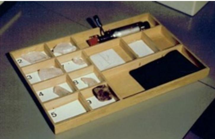
Petite boîte de test comprenant les minéraux de dureté de 2 à 9, une plaquette de porcelaine pour l'essai du trait, une lamelle de verre qui permet de tester si la dureté d'un minéral est supérieure ou inférieure à 6.5 (dureté du verre), un étui comportant des tiges de test de dureté et un petit chalumeau pour tester la fusibilité. On peut facilement la construire soi-même.
