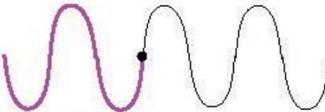
*La **vitesse** de propagation de l'onde se calcule par la distance parcourue, exprimée en longueurs d'onde, divisée par le temps nécessaire à ce parcours. Si, dans ce dessin, on représente le trajet parcouru par le "point" dans un laps de temps qui est le même que pour l'onde d'en dessus (0.2 secondes), son déplacement est alors une fois et demie la longueur d'onde. Ici, la vitesse de l'onde sera donc une fois et demie plus grande que pour l'onde d'en dessus.*
