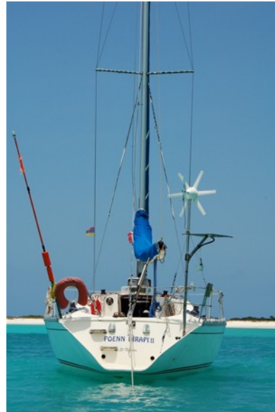
Petite éolienne destinée à la recharge de batteries sur un bateau de plaisance
