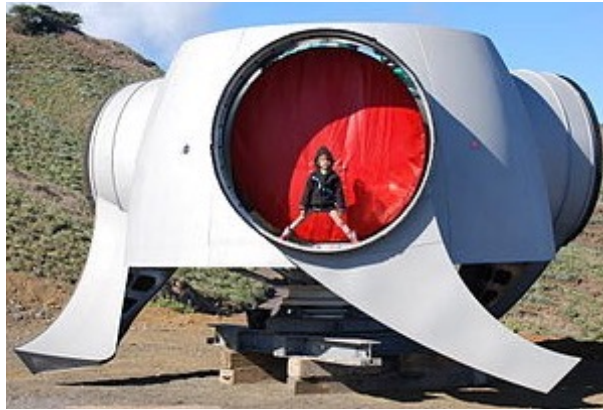
Moyeu sur lequel les pales ont sont fixées
