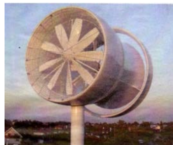
Petite éolienne destinée à la recharge de batteries sur un bateau de plaisance
