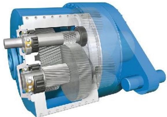
Multiplicateur et son schéma de fonctionnement
