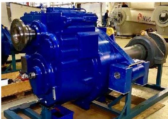
Multiplicateur et son schéma de fonctionnement
