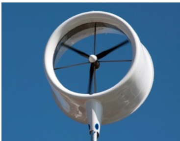
Petite éolienne à nombreuses pales destinée à pomper l'eau
