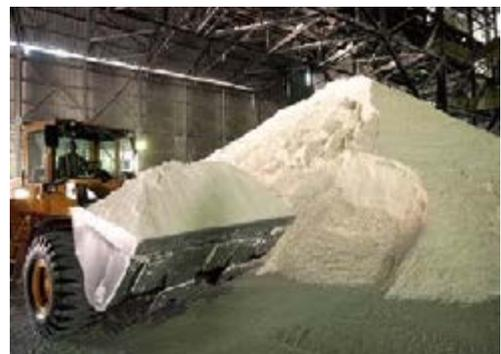
*Alumine prête pour l'électrolyse*
