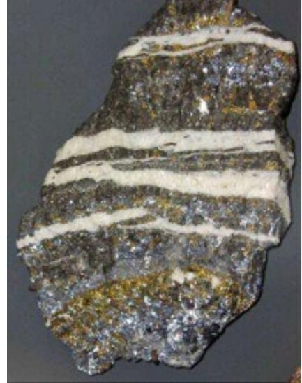
Bandes alternés de blende, chalcopryrite et galène et de quartz dans un filon hydrothermal
