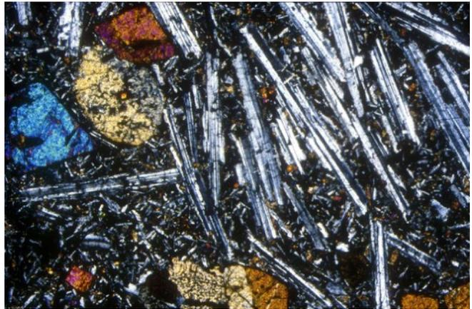
*Baguettes de plagioclases dans un basalte vu au microscope polarisant.*
