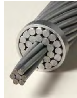
Structure d'un câble pour ligne aérienne à haute tension : âme centrale en acier pour la résistance mécanique, conducteur électrique extérieur en aluminium.
