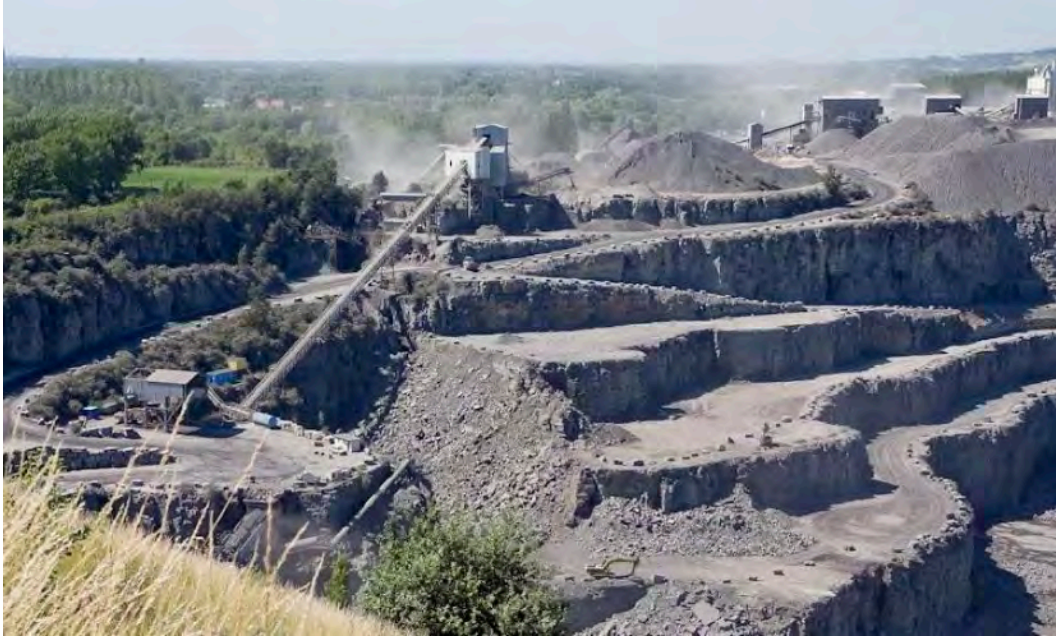
Exploitation de calcaire argileux pour la production de ciment. Carrière Lemay, Belgique
