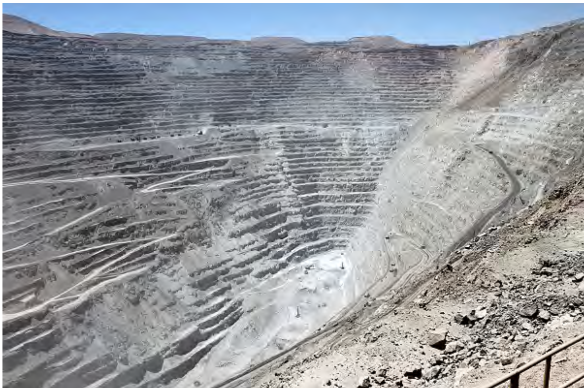
Mine de cuivre à ciel ouvert de Chuquicamata au Chili. Pour donner une idée des dimensions, la hauteur de chaque gradin est de 26 mètres.
