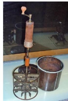
L'appareillage original utilisé par Joule
