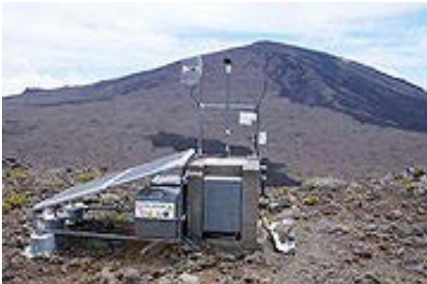
*Piton de la Fournaise : installation GPS (et sa station d'alimentation électrique solaire) utilisée pour surveiller les déformations du volcan.*
