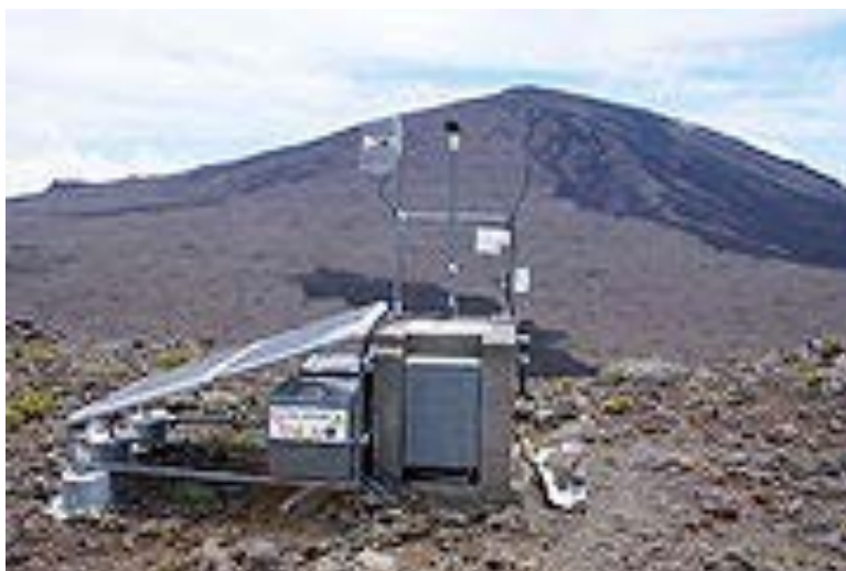
Piton de la Fournaise : installation GPS utilisée pour surveiller les déformations du volcan.
