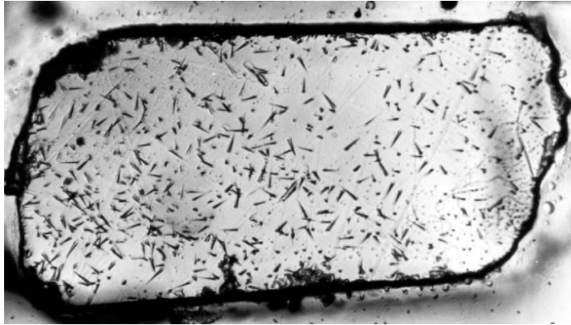
Traces de fission obtenues par attaque d'une surface polie d'un cristal d'apatite avec de l'acide chlorhydrique.
