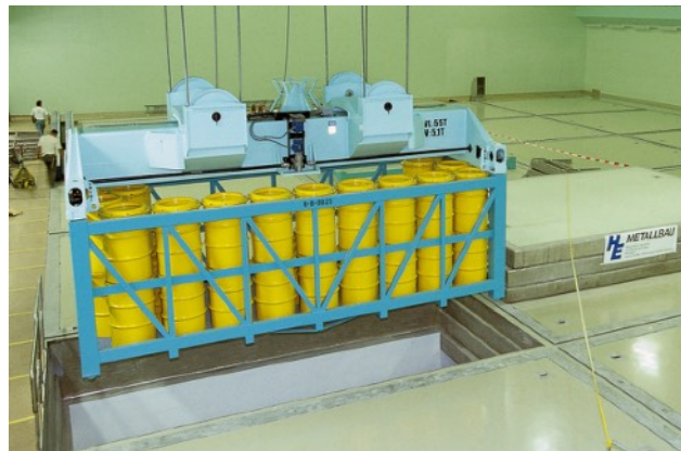
Les fûts sont stockés dans des sarcophages en béton recouverts d'une dalle.
